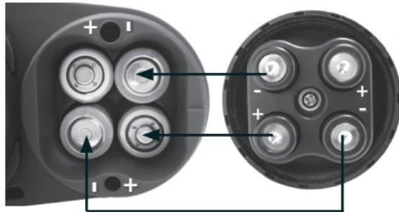
Respecter les marques de polarité des piles à l'intérieur du compartiment à piles au moment d'insérer celles-ci, et s'assurer que les marques de polarité du chapeau correspondent à la polarité du compartiment à piles lors de la repose du couvercle (+ sur + et - sur -).
