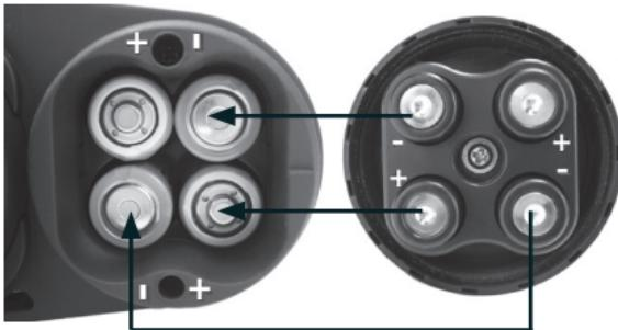
Observe las marcas de polaridad dentro del compartimento cuando instale baterías y, al sustituirlas, asegúrese de que las marcas de polaridad en los extremos coincidan con las marcas en el compartimento (+ con + y - con -).
