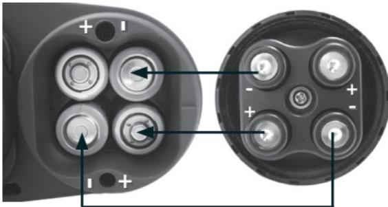
Durante l'inserimento delle batterie, rispettare i segni di polarità delle stesse all'interno del vano batterie e, in caso di sostituzione del coperchio, assicurarsi che i segni di polarità sullo stesso corrispondano a quelli nel vano batterie (da + a + e da - a -).
